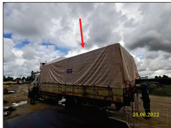
รูปที่ 2-6 การใช้ผ้าใบปิดคลุมรถบรรทุกระหว่างการขนย้ายวัสดุ
